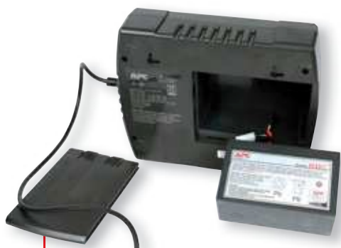
Takto jednoduše může vypadat výměna staré baterie za novou
