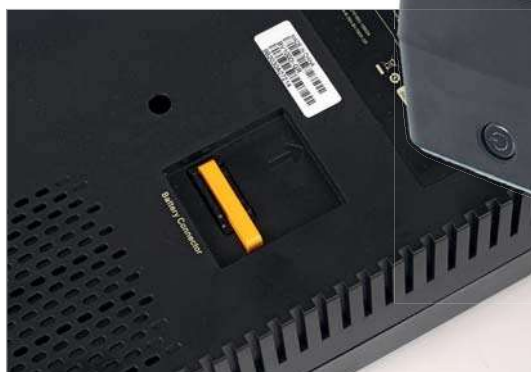
UPS od APC umožňují úplné odpojení baterie, což se hodí třeba v případě, že nebudete UPS delší dobu používat
