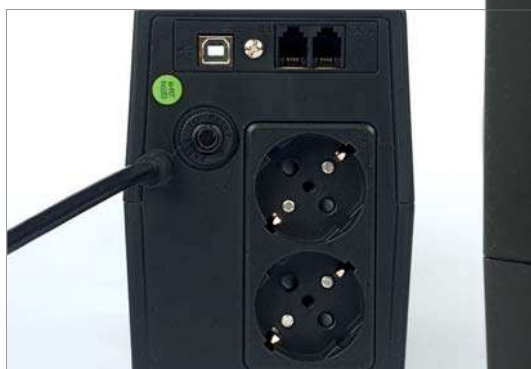
Dalšími chráněnými konektory jsou pouze RJ11, což přijde vhod snad jen těm, kdo mají vedle počítače VDSL router
