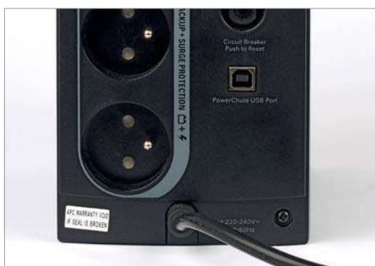
Vlevo dole překrývá šroubek záruční pečeť, takže v případě jejího porušení přijdete o záruku
