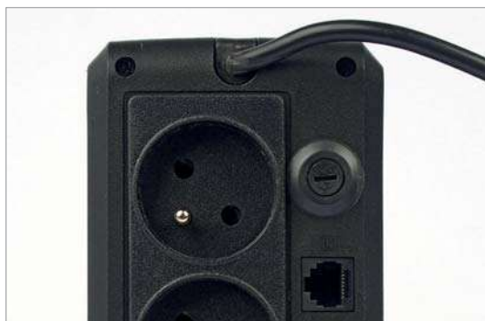
Neodpojitelný přívodní kabel je umístěn trochu nešikovně v horní části
